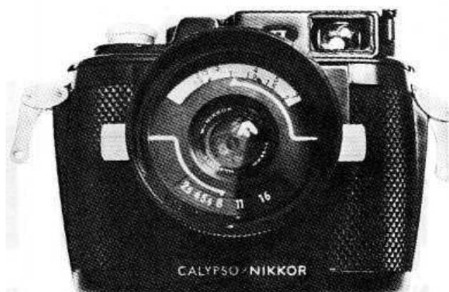
**Nikon Calypso Nikkor II.** Appareil pour prise de vue sous-marine. Objectifs 2,8/15 mm, 3,5/28 mm, 2,5/35 mm et 4/80 mm. Viseur collimaté et viseurs spéciaux sous-marins. Obturateur mécanique : 1/30 à 1/500 s. Synchronisation X sur 1/60 s. Étanchéité par joints toriques en caoutchouc synthétique. 129 x 99 x 69 mm. Poids : 700 g à terre, 250 g en plongée. Prix moyen : **1 500 F** avec 2/35 mm.
