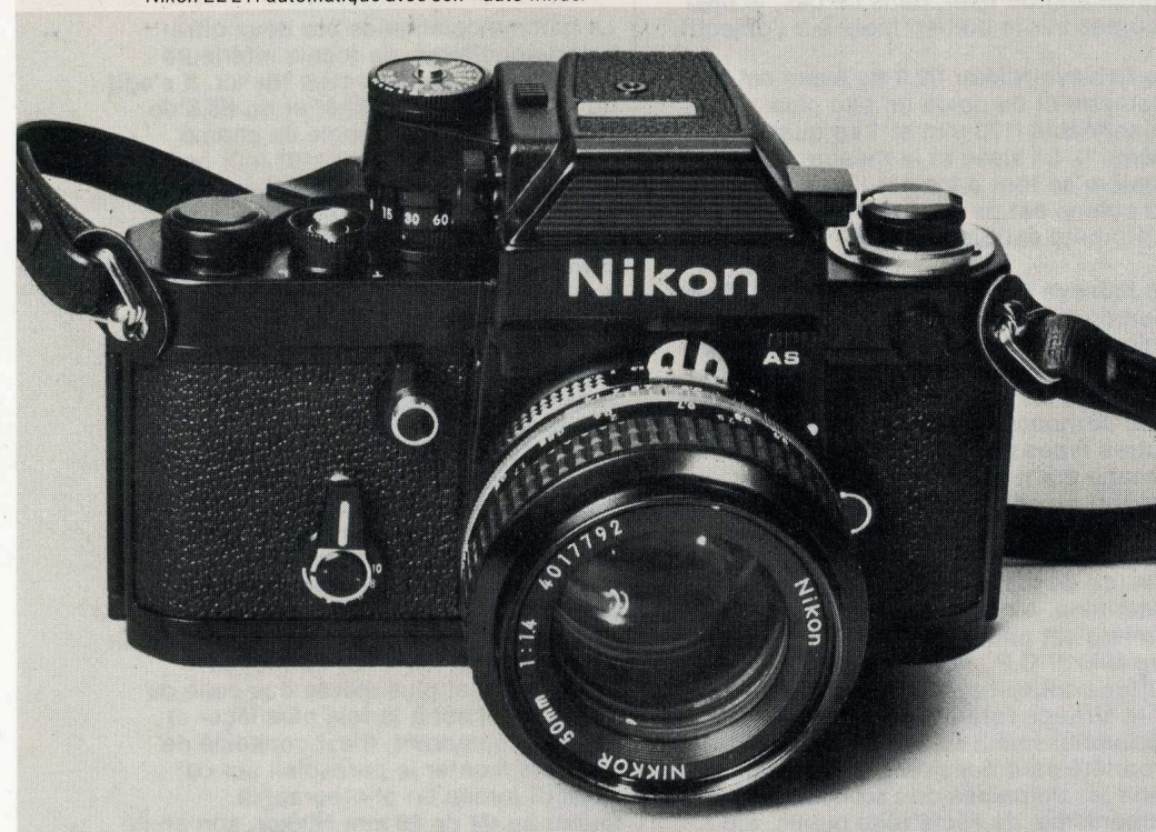
Nikon F2-AS: c'est le même boîtier que le F2-A mais le viseur diffère
