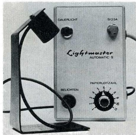
Le Lightmaster Automatic S de Franclair Electronique, très proche du précédent, possède une sonde de conception plus simple. Le boîtier, parallélépipédique, à poser à la verticale sur une table disjoncte jusqu'à 2,5 A.
