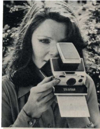
Cette photographie montre le SX 70 au moment où l'opératrice vient d'appuyer sur le déclencheur avec l'index. La photographie est aussitôt éjectée de l'appareil, commençant déjà à se développer.
