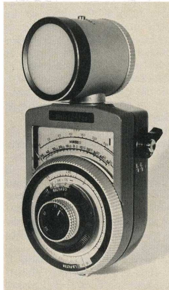
Sur la droite du thermocolorimètre Minolta Color Meter, le commutateur de sélection : lux-mètre ; vert/rouge ; bleu/rouge
