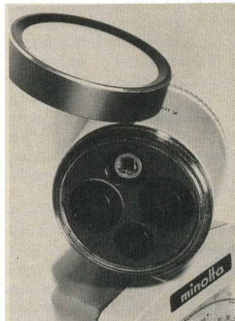
Sous le disque intégrateur du Minolta Color Meter, on aperçoit, derrière un filtre vert, les quatre photodiodes.
