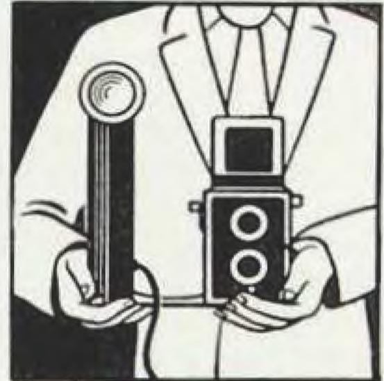
Position normale, visée sur dépoli, doigt sur le déclencheur. Mise au point aisée de la même main.
