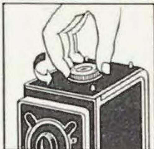
Ouvrir le dos en tournant le verrou de fermeture.
