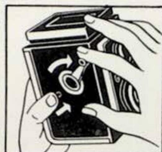
Pousser le bouton d'embranchage avec le pouce et manœuvrer la manivelle jusqu'au blocage. Le compteur est automatiquement sur le n° 1 (Semflex Otomatic).
