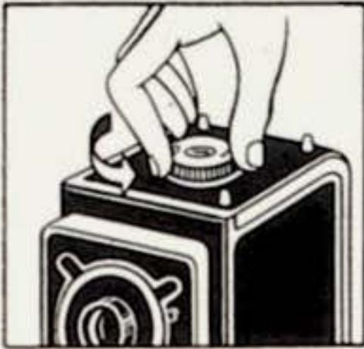
Ouvrir le dos en tournant dans le sens de la flèche le verrou de fermeture.
