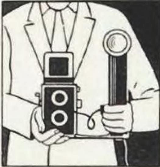
Position normale, visée sur dépoli, doigt sur le déclencheur. Main droite prête à avancer le film.
