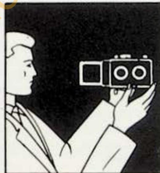
Visée de côté à hauteur œil (vues en largeur avec le format Bantam).
