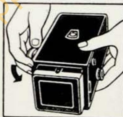
Tourner le bouton d'avancement du film en surveillant l'arrivée du n° 1 dans la fenêtre placée au milieu du dos (Semflex Standard).
