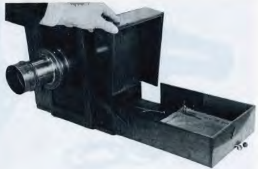
Appareil de G. Hare. A droite, on aperçoit la cuvette à l'intérieur de l'abattant
