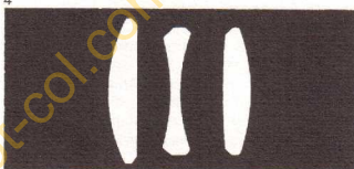
3. Vue de l'objectif Trinar qui se fait en 3 focales différentes : 50, 75 et 105 mm.
