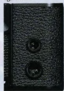
Câble d'alimentation extérieure Permet au convertisseur MA-4 AC/DC d'être relié au MD-4. Câble de télécommande Permet d'adapter différents appareillages de télécommande.
