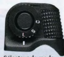
Sélecteur de mode S-C La position "L" (verrouillage) existe également.
