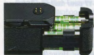
Logement des piles Accepte huit piles de type AA.
