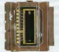
Avec le F-501, l'image à travers l'objectif est détectée par les Dispositifs à Transfert de Charge sur le module du capteur AF. Grâce au fait que tous les éléments y compris le filtre, la lentille de séparateur et les Dispositifs à Transfert de Charge sont virtuellement incorporés dans un module du capteur AF à un seul substrat, le système AF du F-501 est fondamentalement fiable et utile.
