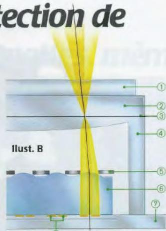
① Filtre, ② Couvercle, ③ Plan focal imaginaire, ④ Objectif, ⑤ Plaque de masquage, ⑥ Réseau lenticulaire d'entrée, ⑦ Substrat céramique, ⑧ DTC
