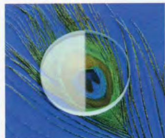
Seule la moitié droite de la lentille est traitée NIC.
