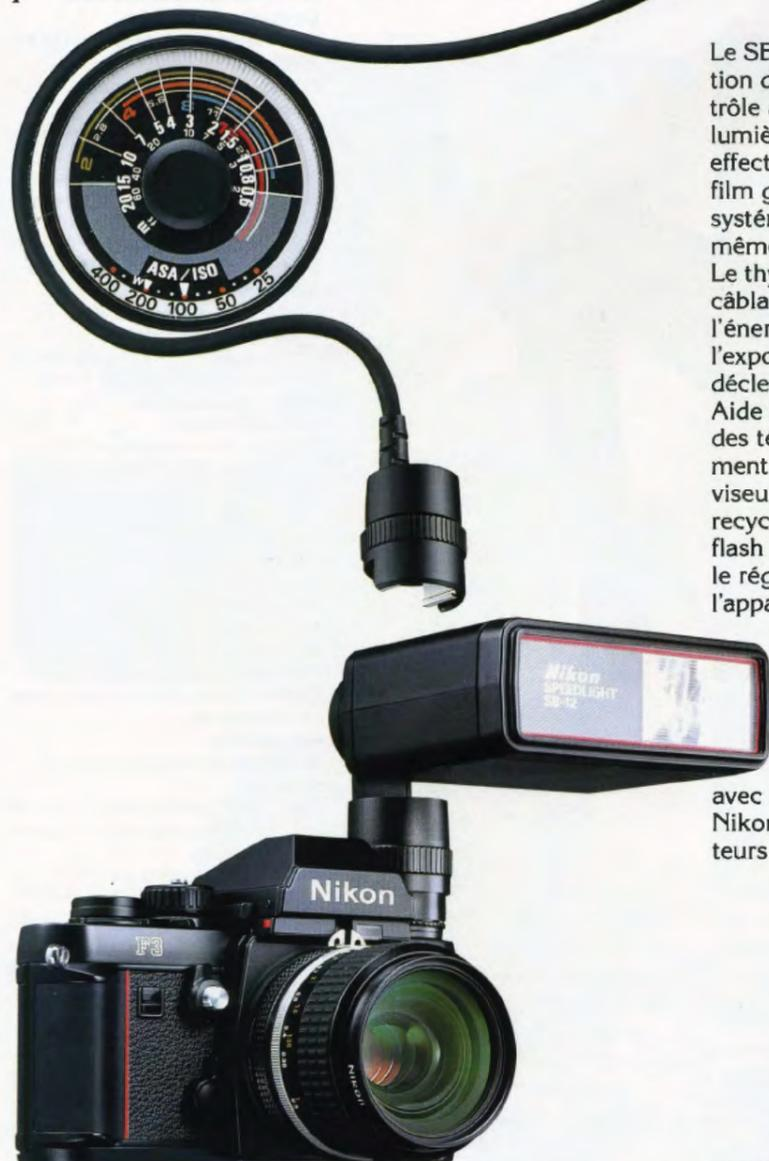
Le SB-12 est un flash à fixation directe assurant le contrôle automatique TTL de la lumière émise. La mesure effectuée directement sur le film garantit une exposition systématiquement parfaite, même en cas de filtrage. Le thyristor (SCR) et le câblage en série préservent l'énergie tout en assurant l'exposition correcte à chaque déclenchement.
