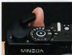
Le levier d'armement permet une avance douce et rapide du film sur une course unique de 130°.
