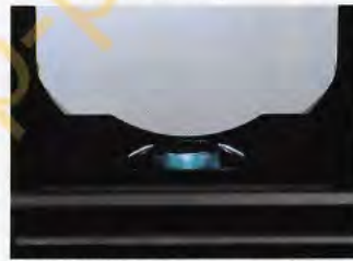
Module L/M/P: Spécialement conçu par Minolta, le module du CLE est constitué de lentilles/miroir/prisme et représente une innovation signée Minolta. Situé derrière l'objectif, il a pour fonction de concentrer la lumière réfléchie sur la photo-cellule afin d'obtenir une mesure exacte de l'exposition.
