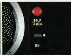
Le retardateur assure un délai de 10 secondes environ avec une DEL à deux fréquences de pulsation.
