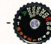
Position "T" pour obtenir une exposition longue de quatre minutes.
