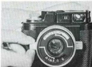
Afficher la vitesse d'obturation. Régler le diaphragme en tournant le bouton correspondant. Effectuer la mise au point en tournant le bouton de mise au point.
