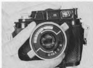
Placer les extrémités, les deux leviers-crochets sous les ergots qui débordent latéralement du dessus du boîtier et les abaisser simultanément de façon à extraire doucement le mécanisme interne de l'appareil.
