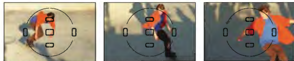
AF dynamique : la mise au point reste maintenue sur le sujet même s'il sort de la zone de mise au point sélectionnée, ceci en décalant automatiquement la mise au point sur la zone où il se trouve.
