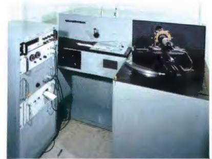
Test de fonction de transfert de modulation
