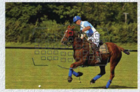
Le suivi 3D suit le sujet en sélectionnant un nouveau point AF dès que nécessaire.
