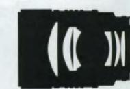
Construction optique : 6 lentilles en 6 groupes Distance minimale de mise au point : 0,9 m Champ angulaire avec le format DX Nikon : équivalent à celui d'un objectif 157,5 mm au format 24 x 36
