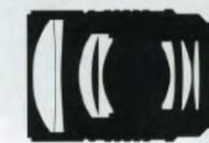
Construction optique : 7 lentilles en 6 groupes Distance minimale de mise au point : 1,1 m Champ angulaire avec le format DX Nikon : équivalent à celui d'un objectif 202,5 mm au format 24 x 36
