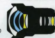
Construction optique : 14 lentilles en 11 groupes Distance minimale de mise au point : 0,28 m (avec une focale de
