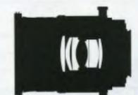
Construction optique : 6 lentilles en 5 groupes Distance minimale de mise au point : 0,39 m Champ angulaire avec le format DX Nikon :
