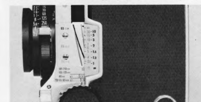
L'objectif de 80mm, réglé sur une distance de 1,2m
