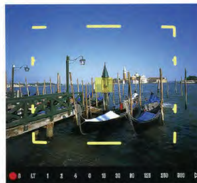
Affichage du viseur de l'objectif 80mm-Vue claire avec index panoramique. Domaine télémètre clair au centre. Lumière rouge de prévention en bas à gauche, vitesse d'obturation au centre et signal de surexposition à droite.
