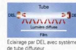
Eclairage par DEL avec système de tube diffuseur
