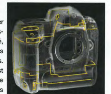
Principaux points où les joints protègent le boîtier de l'humidité et de la poussière
