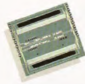
200 photodétecteurs DTC pour la mise au point
