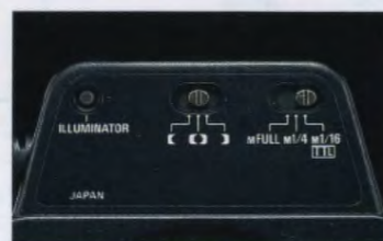
Illuminateur pour mise au point L'illuminateur intégré du SB-21 se révèle bien pratique pour effectuer la mise au point dans les conditions défavorables de lumière ou de visée.
