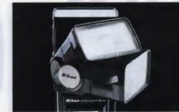
Réflecteur basculable/orientable Faites preuve de créativité. Vous pouvez basculer la tête jusqu'à 90° vers le haut en cinq positions crantées ou l'orienter sur 270° (90° dans le sens horaire — trois positions crantées; 180° dans le sens horaire inversé — six positions crantées). Ou encore combiner les deux.
